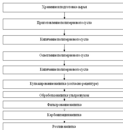
Рис. 5. Технологическая схема производства полизернового напитка
