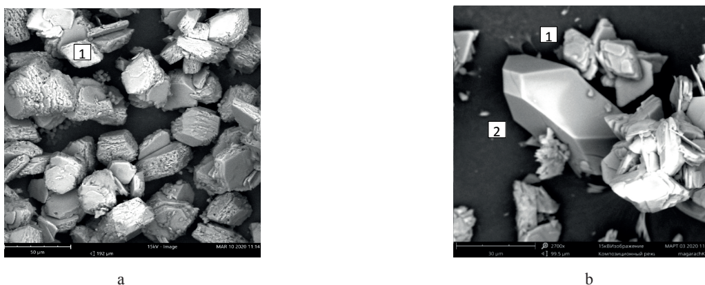
Рисунок 5. Сканирующая электронная микроскопия. Кристаллический осадок, образовавшийся в красном вине: а – гидротартрат калия; б – гидротартрат калия (1) и тартрат кальция (2)
