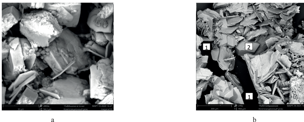
Рисунок 4. Сканирующая электронная микроскопия. Кристаллический осадок, образовавшийся в белом вине: а – гидротартрат калия; б – гидротартрат калия (1) и тартрат кальция (2)
