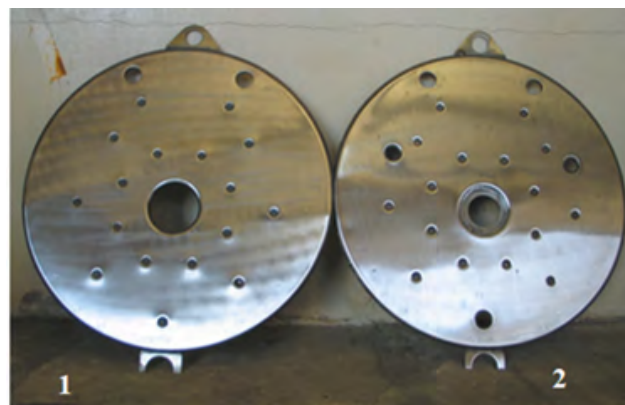
Рисунок 2. Общий вид пластин: 1 – пластина с центральной подачей продукта; 2 – пластина с периферийной подачей продукта
