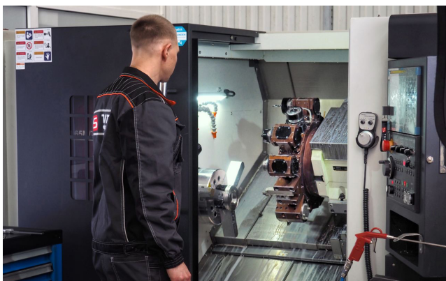
Рисунок 2. Токарная операция процесса производства трубных вставок для теплообменного оборудования TDNT Engineering
