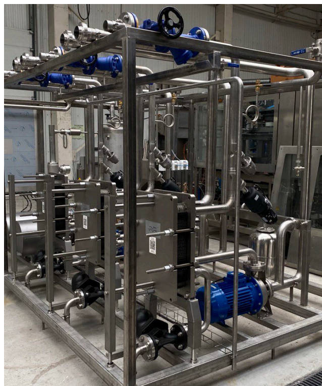
Рисунок 3. Пастеризационно-охладительная установка производства TDNT Engineering
