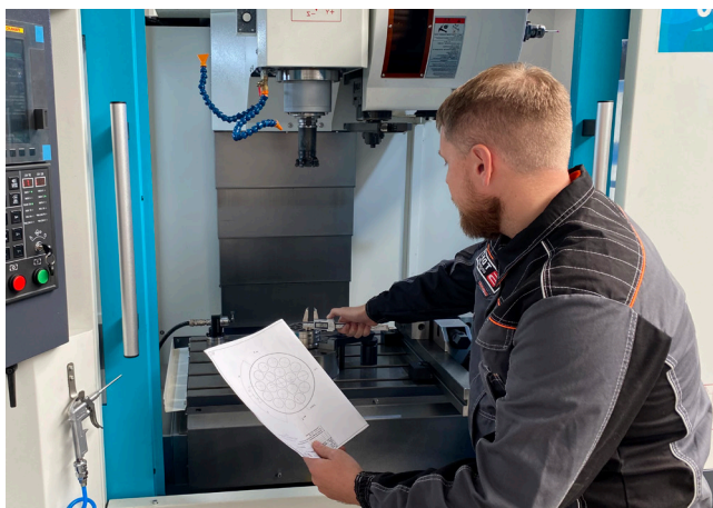
Рисунок 5. Фрезерная операция процесса производства трубных вставок для теплообменного оборудования TDNT Engineering
