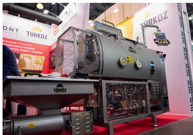
Котел-плавитель на 100 кг производства Türköz (Турция)
